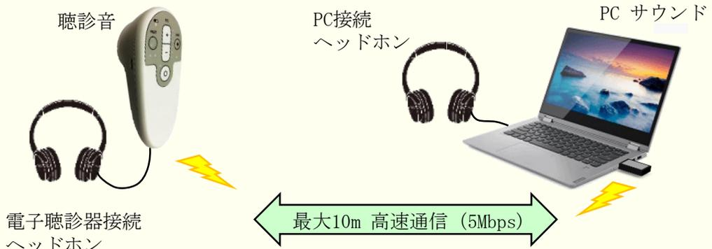
本品は、最大10mの範囲で送受信可能な2.4GHz帯無線機器（技術認証済）を使用しています。障害物（壁、家具や人）が本品と通信可能な外部機器との間にある場合には、電波の送受信可能範囲は減衰します。無線通信の送受信を問題なく行うためには、本品と外部機器の間の距離を短くするか、あるいは間に障害物を置かないことが望ましいこととなります。
